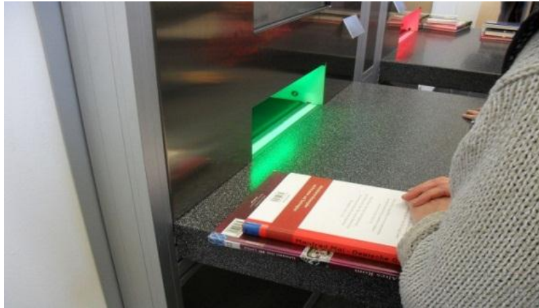
Figuur 9: RFID-systeem voor een bibliotheek (bron: LIU/WikimediaCommons)
