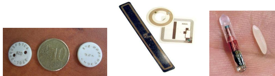
Figuur 3: Verschillende soorten RFID-tags (bron: Sancho, Grika, LightWarrior/WikimediaCommons)
